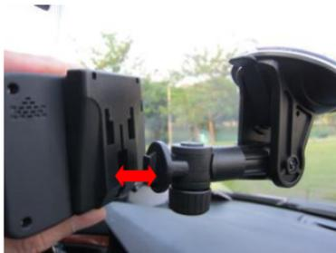
3. 固定機器時請確認 LT-Q6000 垂直且保持直立以使內部 3 軸動力感測器達到最佳效能。
